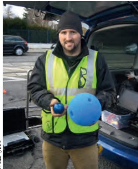
Abb. 2a – Kleine kluge Kugel: Der SmartBall verbirgt in seinem Inneren einen knapp 6,5 Zentimeter großen Aluminiumkern.
